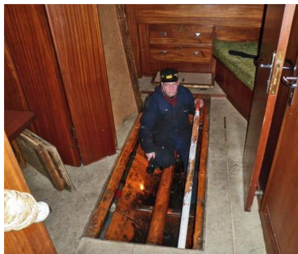
I tunneln under golvet i aktersalongen löper axeln som förenar maskin och propeller. Mellandelen på axeln är lika lång som åran Leif har med sig. Han mäter med åran om det finns utrymme att plocka ut axeln.
