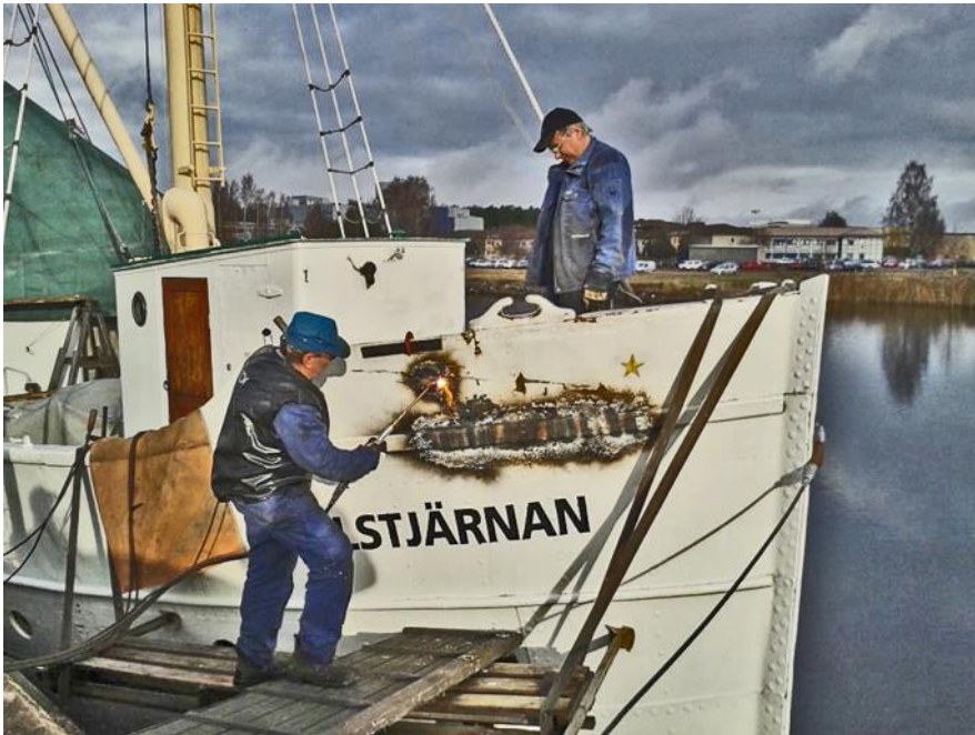
Sören Häggkvist, Kils Smide AB, lagar bucklor på Polstjärnans bordläggning, assisterad av Leif Hassel.
