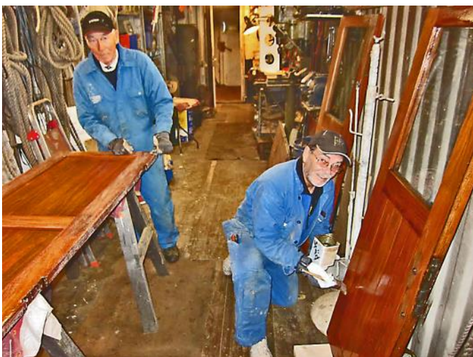
Underhållsarbete pågår ständigt på båtarna. Eje Andersson t.v. och Hans Hartman slipar och lackar hytt dörrar
