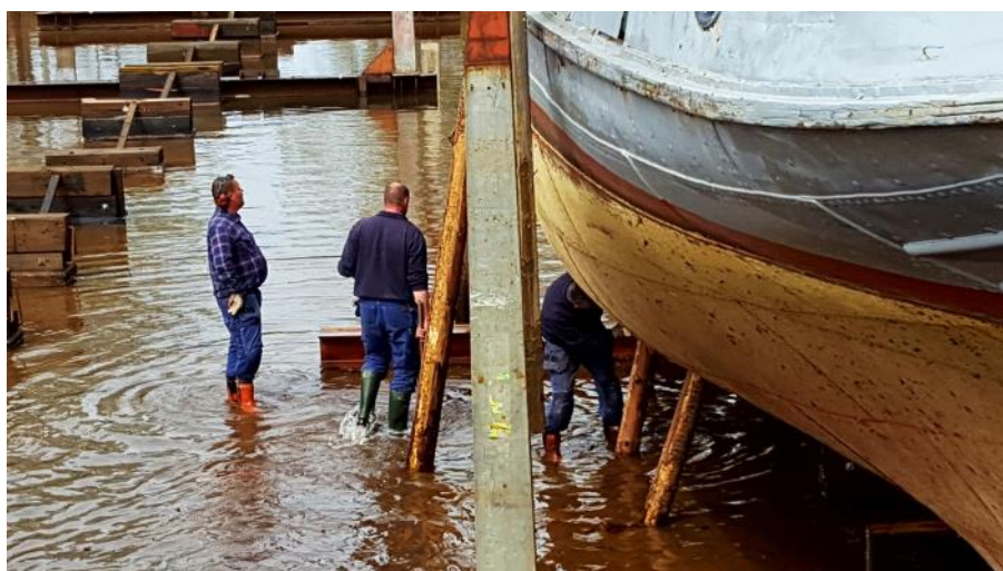
Stöttningen kontrolleras medan sista vattnet lämnar dockan.
