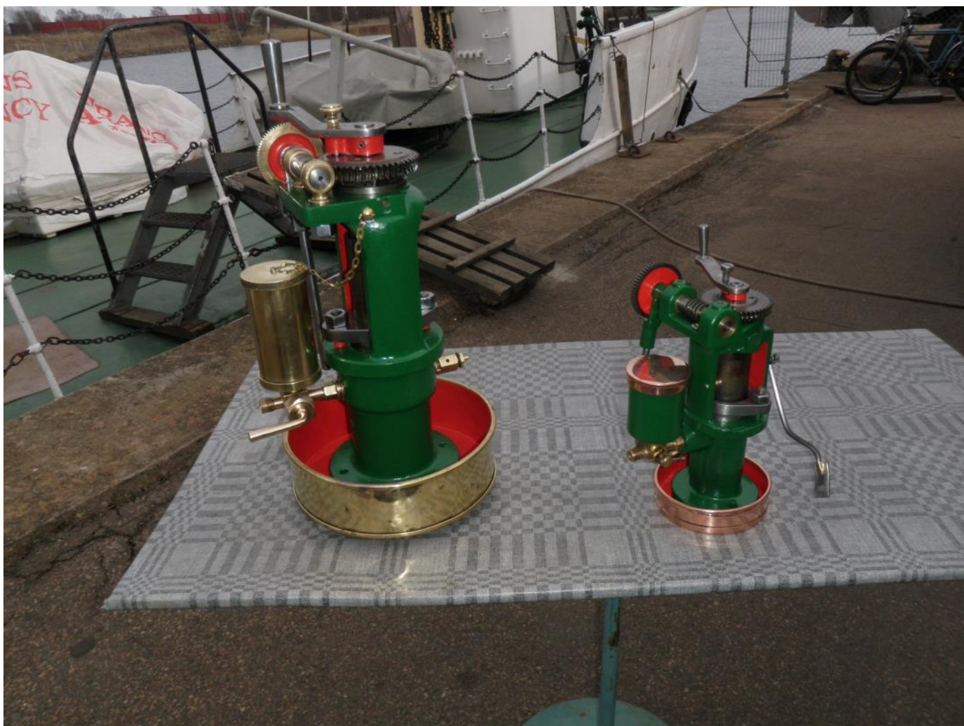
Två av tre renoverade cylindersmörjpressar.
