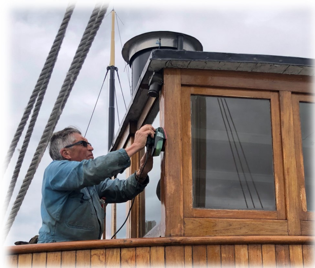
Vårrustning - Slipning av styrhytt inför fernissning av Olle D och mässingputs Peter H.
